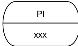
Oval mit Doppelstrich – Hartverdrahtung mit Fernwirkanlage (FWA)
