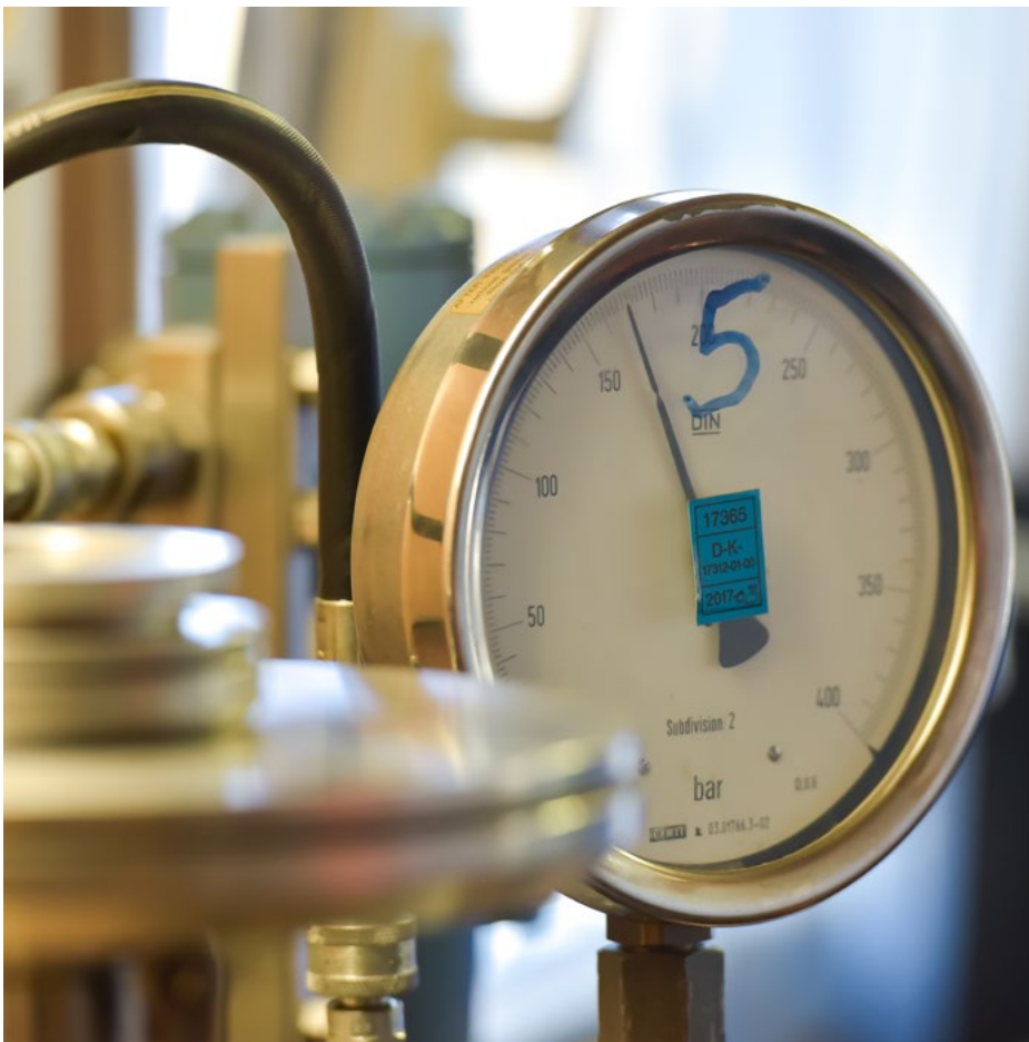
Mehr als 160 bar betrug der maximale Prüfdruck auf den einzelnen Abschnitten der Neckarentalleitung
